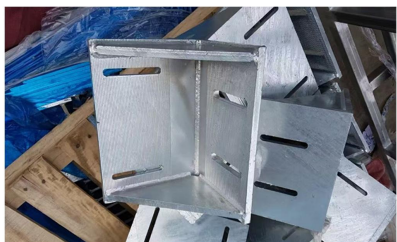
基层后置埋件焊接
